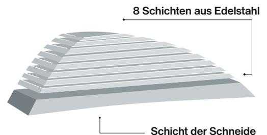
Die moderne Form der Herstellung ist eine aus mehreren sichtbaren Lagen bestehende Legierung die in Kombination mit einem Kernstahl verarbeitet wird. Das Ausgangsmaterial zur Herstellung des modernen Damaszenerstahls sind Stähle mit unterschiedlichen Gehalten an Begleitelementen.
